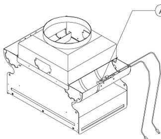
Датчик уходящих газов служит для контроля правильного дымоудаления в приборах с естественной тягой. Он располагается на коробе уходящих
